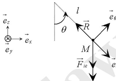
On exprime les différentes forces agissant sur  $M$  en utilisant la base cylindro-polaire et le vecteur  $\vec{e}_z$  de la base lié au référentiel terrestre.
