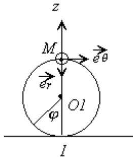
La vitesse d'entraînement est la vitesse d'un point fixe  $I'$  de  $\mathcal{R}'$  coïncident avec le point  $I$  à la date  $t$  et que l'on évalue dans le référentiel  $\mathcal{R}_T$ . Le point  $I'$  décrit un cercle de rayon  $R$  à la vitesse angulaire  $\omega$ . La vitesse d'entraînement a donc pour expression :
