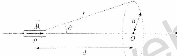
1. On note  $\Phi = KM$  le flux magnétique à travers la spire. Déterminer par un calcul direct du flux traversant la spire l'expression de  $K$  en fonction de  $\mu_0, a$  et  $D$ .
