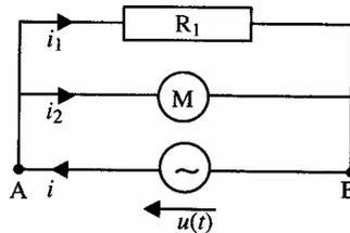
On branche un appareil de chauffage uniquement résistif qui consomme une puissance moyenne  $P_1 = 1$  kW et un moteur inductif (modélisable par une résistance A et une réactance B :  $Z = A + j B$ ) de puissance moyenne  $P_2 = 2$  kW et de facteur de puissance  $\cos \phi_2 = 0,5$ .
