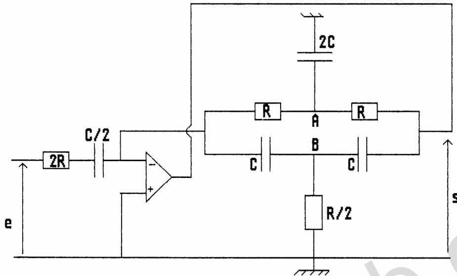
Déterminer la fonction de transfert du montage dans le cas où l'A.O. est idéal et en fonctionnement linéaire. Le comportement du montage dépend-il de la présence d'une impédance de charge ?
