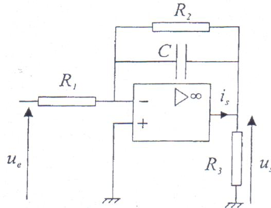
L'amplificateur opérationnel est supposé idéal et en fonctionnement linéaire.
