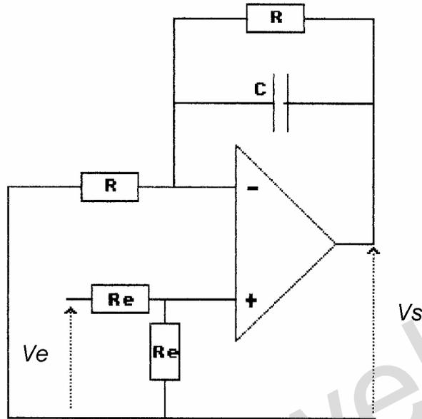
Déterminer la réponse à un échelon de tension :  $V_e = 0$  pour  $t < 0$  et  $V_e = E$  pour  $t \geq 0$ .
