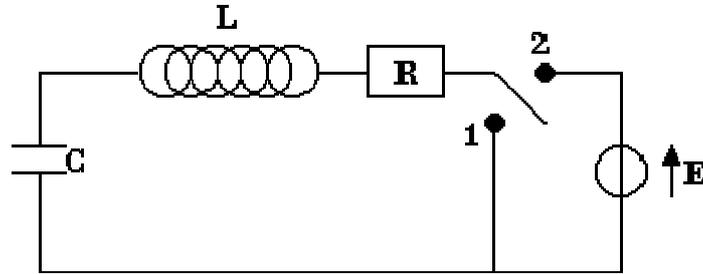
L'interrupteur  $K$  étant en position (2), on le bascule en position (1) à l'instant initial  $t = 0$  où la charge du condensateur est  $q_0$ . On supposera le circuit  $RLC$  faiblement amorti :  $\lambda \ll \omega_0$ .
