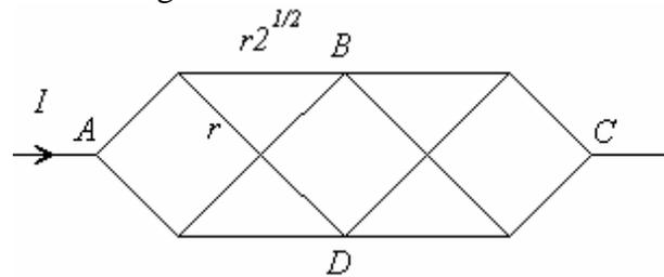
Déterminer la résistance équivalente entre les points A et C.
