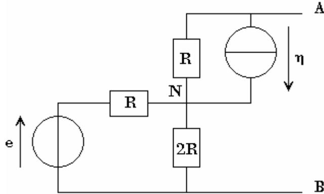
2. Déterminer les caractéristiques,  $R_N$  et  $\eta_N$  du générateur de Norton équivalent, entre les points A et B, au montage suivant :
