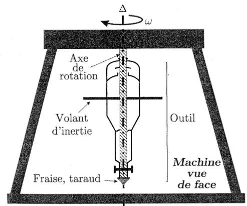
1. Initialement immobile, l'outil est soumis à partir de l'instant  $t = 0$  à l'action d'un couple moteur de moment  $\Gamma = \Gamma_o$  constant.
