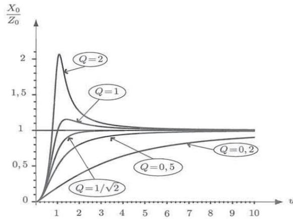
Figure 2. Réponse fréquentielle du sismographe.
