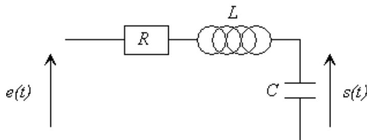
Il est composé de trois dipôles en série : une résistance  $R$ , une inductance parfaite de coefficient d'induction  $L$ , et d'un condensateur de capacité  $C$ .
