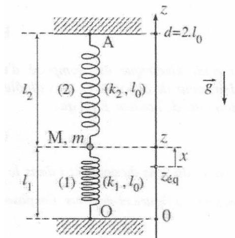
On tient compte des frottements car la masse évolue dans un fluide visqueux qui exerce une force de freinage du type  $\vec{f} = -h\vec{v}$  où  $\vec{v}$  est la vitesse de  $M$  dans  $\mathcal{R}_T$ .
