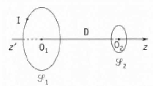
Les deux spires étant initialement immobiles on déplace  $S_1$  d'une distance  $d$ . L'expérience envisagée montre que  $S_2$  se déplace de la même distance  $d$ , et dans le même sens, avant de s'immobiliser.
